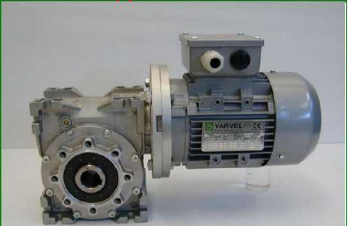
ประกอบคัปปลิงของฝั่งมอเตอร์กับเกียร์เข้าหากัน จากนั้นขันน็อตยึดหน้าแปลนมอเตอร์กับเกียร์ให้แน่น
