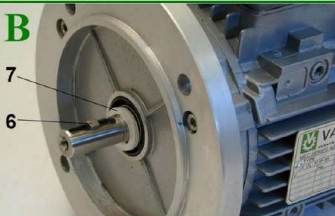
ใส่ลิ่มสั้น(6) กับ SPACER(7) ลงบนเฟลมอเตอร์
