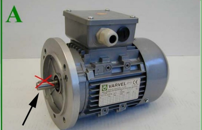
ติดตั้งอันเดมออก(ลิ้มเดมที่ติดมากับเฟลมอเตอร์)
